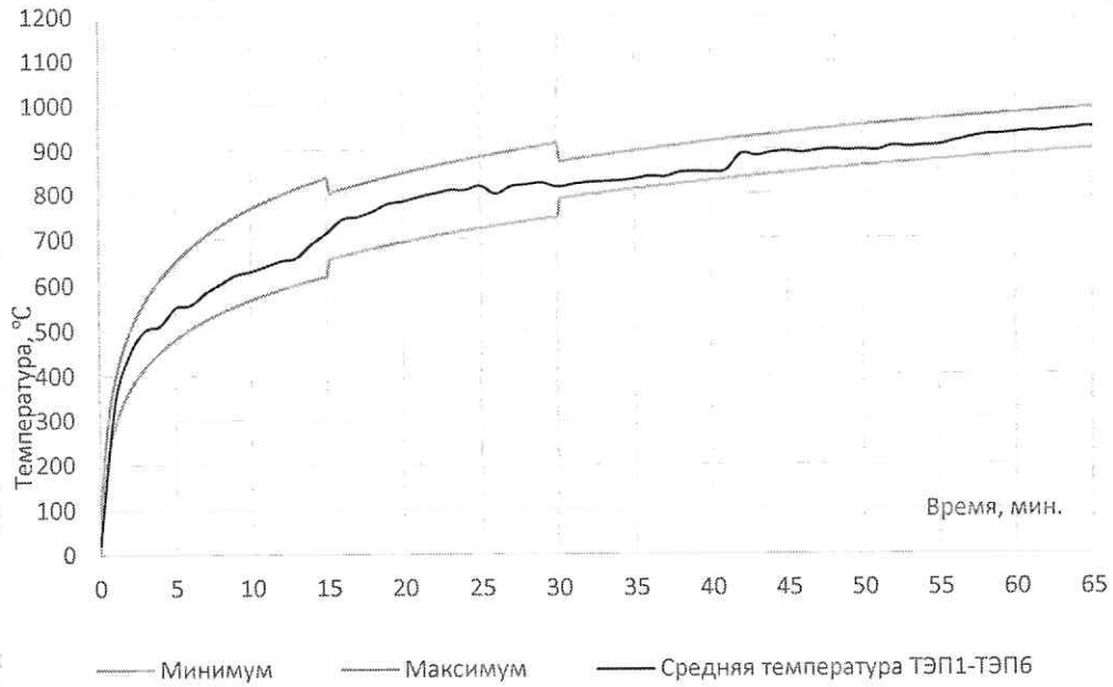
Рис. 3. Изменение температурного режима в огневой камере печи. Образец № 1.
