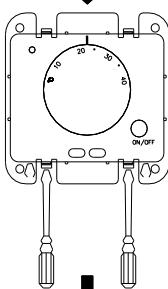
Снимите рамку с терморегулятора,
