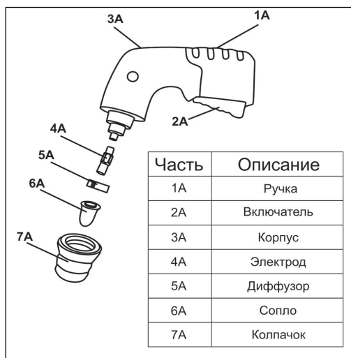
Рис. 10 Составные части горелки
