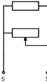
Нагревательный элемент «ИК изображения» с согласующим резистором TD 50/76
