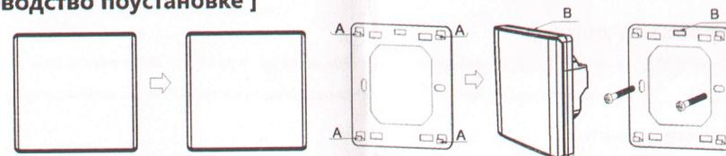
Шаг 1: Отделите поликарбонатный блок от экрана ЖК-дисплея.
