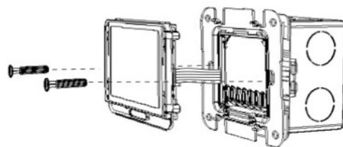
Закрепите терморегулятор в монтажную коробку с помощью винтов
