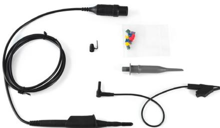
**Изолированная система подключения пробников Rohde & Schwarz разработана с учетом приоритета безопасности. Система соответствует категории безопасности CAT III, а различные наконечники пробников ограничивают риск прикосновения к открытым металлическим поверхностям.**
