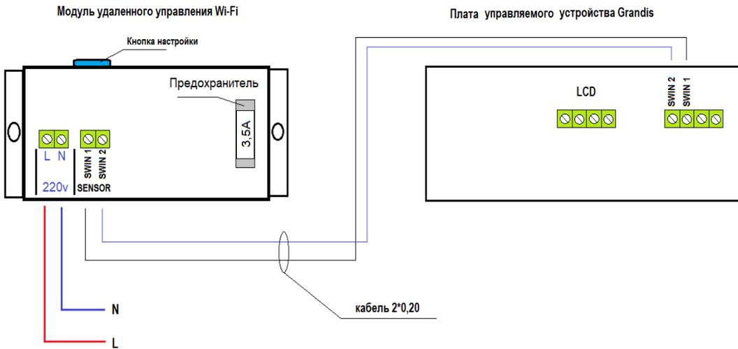
Установите модуль удаленного управления. Подключите напряжение 230В (номинальная частота: 50 Гц). Подключите клеммы **SWIN 1**, **SWIN 2** модуля удаленного управления, с платой управляющего устройства, согласно схеме.
