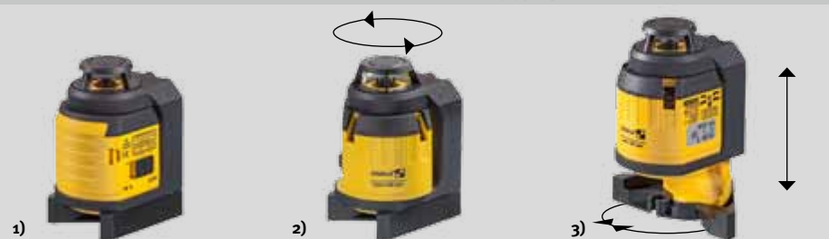
1 — положение при транспортировке. 2 — подвижную часть прибора можно поворачивать внутри корпуса прибора на 360°. 3 — благодаря регулируемой по высоте ножке можно регулировать лазерную линию по высоте. Нижняя опорная часть прибора позволяет устанавливать лазерный прибор, например, на U-образные металлические профили для сухой штукатурки.
