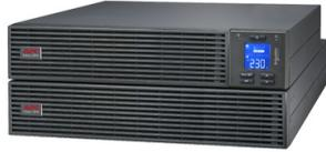
ИБП APC Easy UPS On-Line, 3 кВА/2400 Вт, стоечное исполнение высотой 4U, 230 В, 6 розеток IEC C13 + 1 розетка IEC C19, слот для интеллектуальных плат, ЖК-дисплей, увеличенное время автономной работы, с комплектом направляющих
