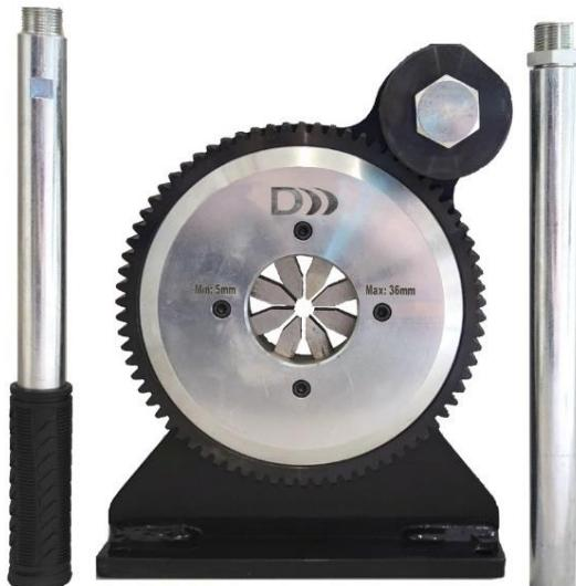
**Ручной опрессовочный станок
