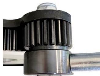
Червячная передача усилия от рычага до кулачков. Гарантия постоянной мощности передачи усилия от рычага на муфту.
