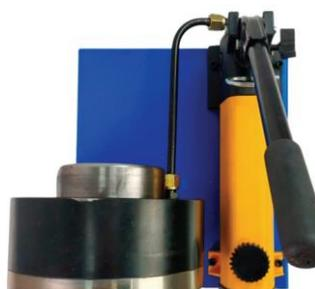
Опрессовка без потери давления: система передачи давления без использования шлангов. Трубка служит дольше и надёжнее.
