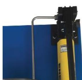
Опрессовка без потери давления: система передачи давления без использования шлангов. Трубка служит дольше и надёжнее.
