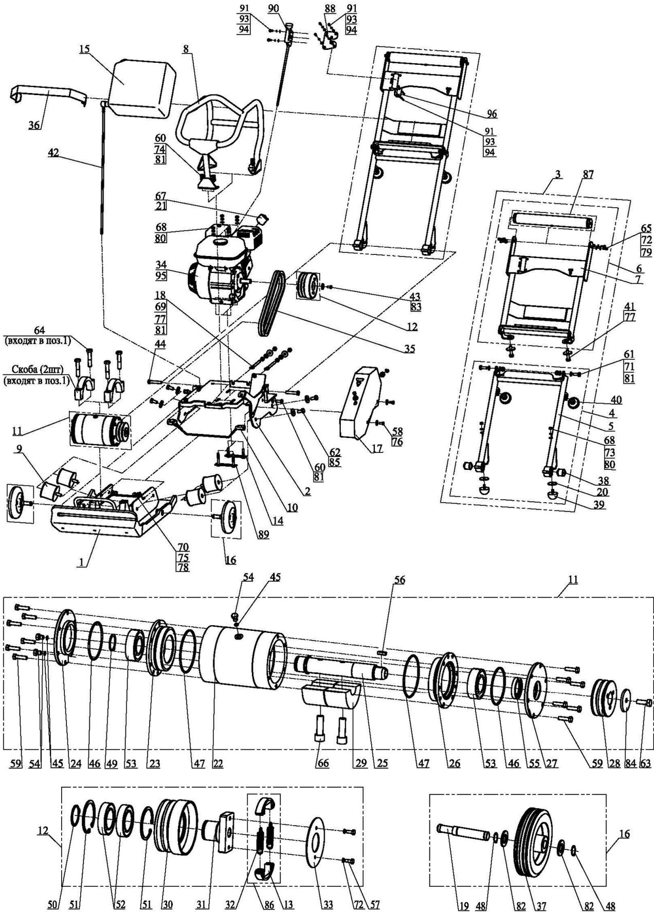
Рисунок 10 – Компоновка виброплиты
