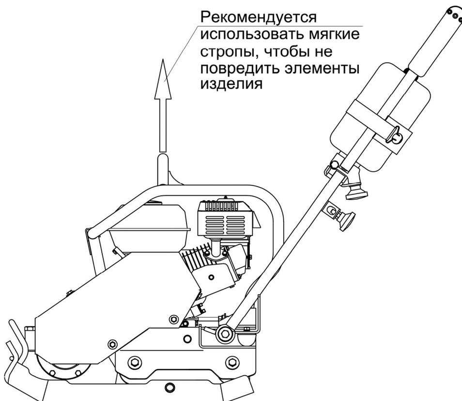
Рисунок 9 – Схема строповки виброплиты при погрузке/разгрузке
