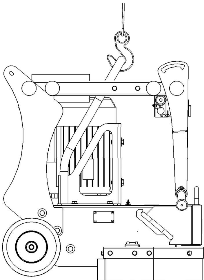
Рисунок 13 – Схема строповки машины при погрузке/разгрузке
