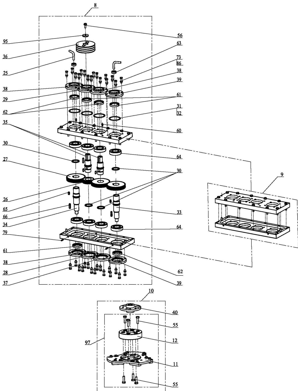
Рисунок 15 – Компоновка машины. Редуктор и траверса шлифовальная
