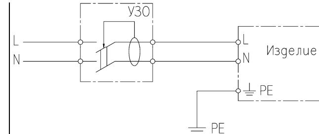
**Рисунок 6б - Схема принципиальная подключения УЗО (GM-122/2.2)**
