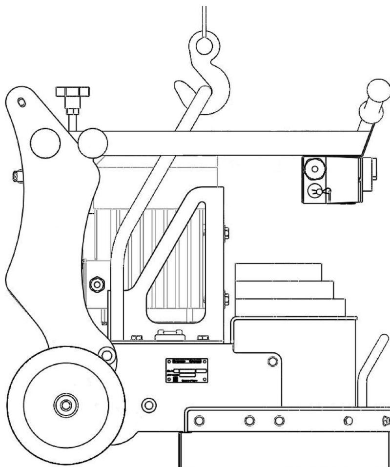
Рисунок 11 – Схема строповки машины при погрузке/разгрузке
