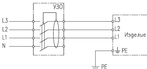
**Рисунок 6а - Схема принципиальная подключения УЗО (GM-122/4.0)**
