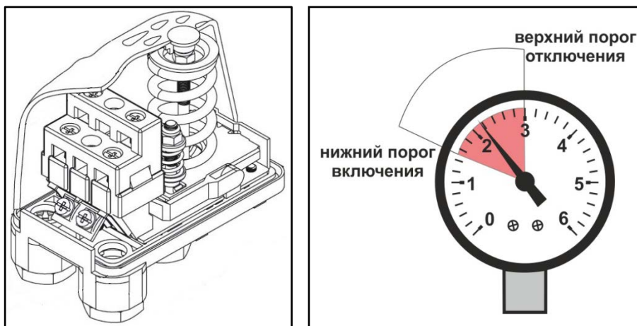
Рис.4 Регулировка реле давления
