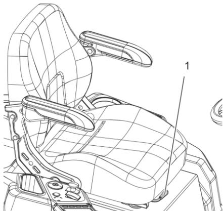
Перед началом работы с косилкой отрегулируйте положение сиденья таким образом, чтобы обеспечить уверенный контакт с педалями акселератора и тормоза.
