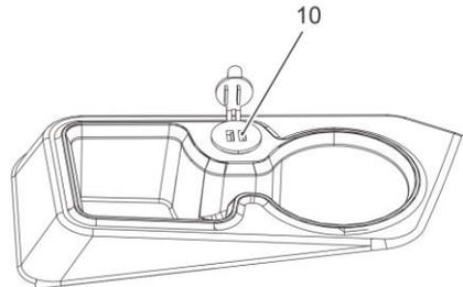
USB порт для зарядки обеспечивает зарядку мобильного телефона, MP3-плеера или других USB-устройств напряжением 5 вольт постоянного тока и силой тока до 2,1 ампер. Обратитесь к руководству пользователя вашего устройства, чтобы узнать о конкретных требованиях к зарядке.
