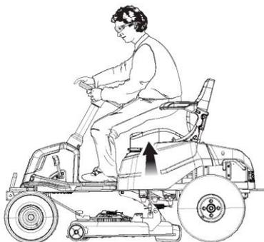
Эта косилка оснащена системой защитной блокировки, которая защищает оператора, отключая ножи, если оператор покидает сиденье при работающих ножах. Проверяйте систему перед каждым использованием, чтобы убедиться в ее правильной работе.
