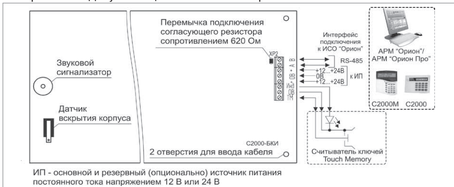
Рисунок 2. Схема внешних соединений блока «С2000-БКИ»
