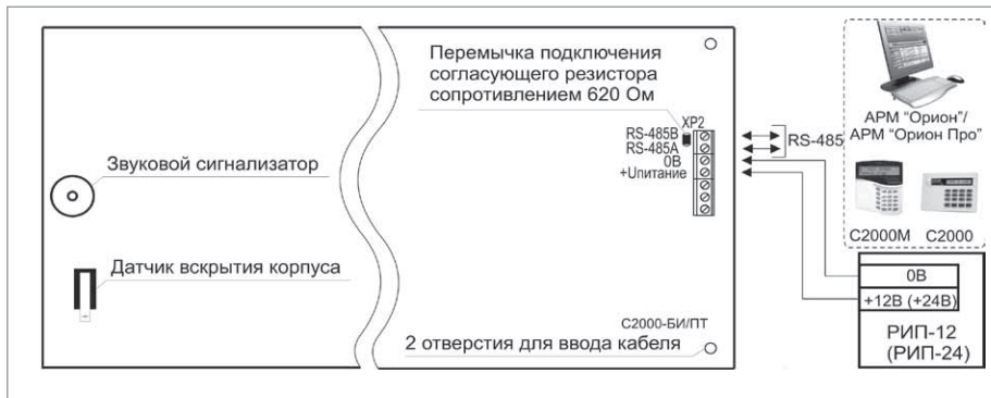
Рисунок 1. Схема внешних соединений блока «С2000-БИ SMD»
