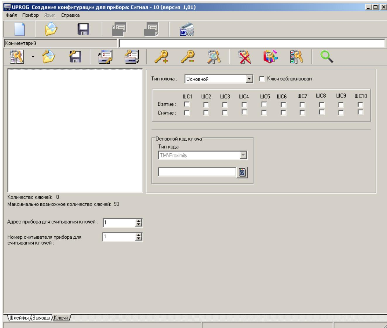
**Рисунок 17. Программирование электронных ключей в программе UProg.exe**
