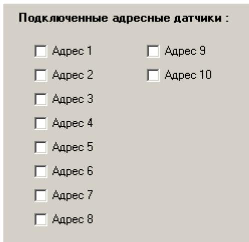
**Рисунок 15. Привязка адресов извещателей к шлейфу типа 14**
