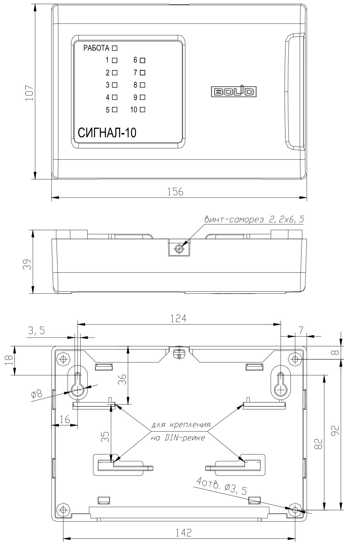
Рисунок 2. Габаритные и установочные размеры прибора Сигнал-10
