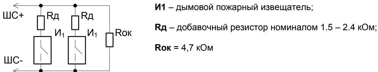
**Рисунок 4. Схема подключения дымовых извещателей в шлейфы типа 1**
