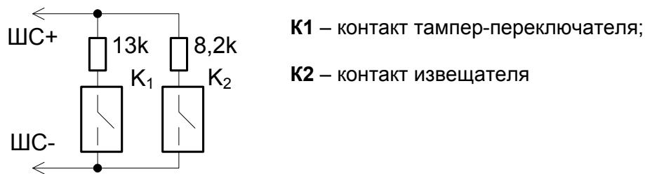
Рисунок 8. Схема подключения охранных извещателей в шлейф типа 5
