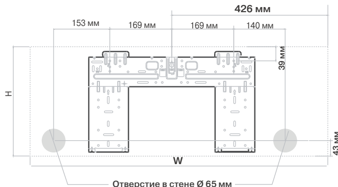
Размеры внутреннего блока (Ш×В): 812 мм x 299 мм
