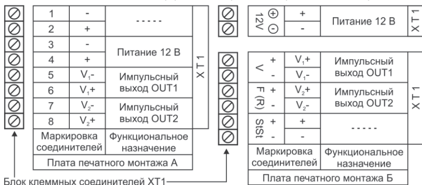
Рисунок 1.5 – Схема подключения внешних цепей
