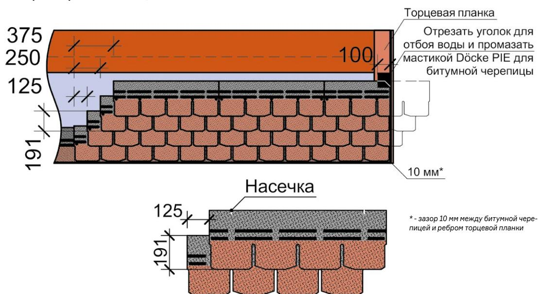
Рис. 23. Схема смещения гонтов по горизонтали и вертикали.
