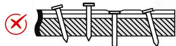
Рис. 3. Пример неправильной забивки гвоздей при монтаже продукции.
