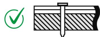
Рис. 2. Пример правильной забивки гвоздей при монтаже продукции.
