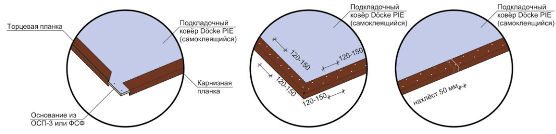
Рис. 13. Крепление металлических карнизных и торцевых планок.
