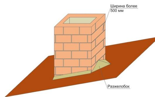
Рис. 29. Примыкание кровли к трубе дымохода шириной более 500 мм.
