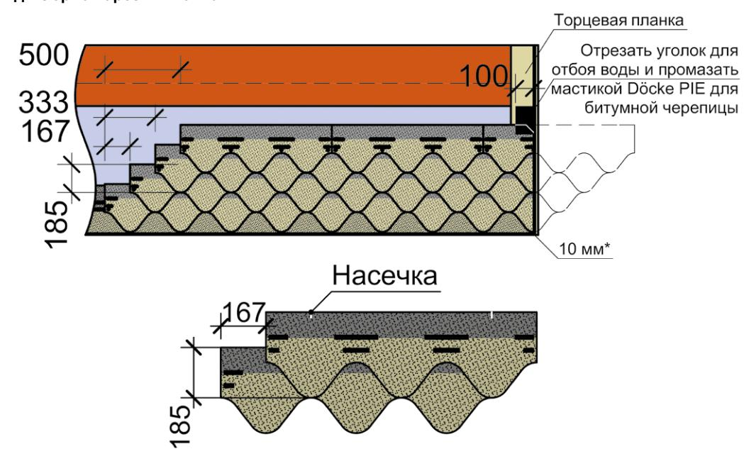
Рис. 23. Схема смещения гонтов по горизонтали и вертикали.
