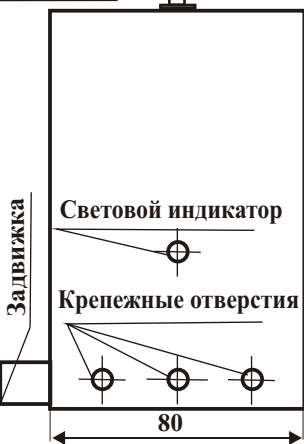
Рис 4 Извещатель пожарный пламени “Пульсар 1-011Н”, “Пульсар 1-011С” со снятой розеткой
