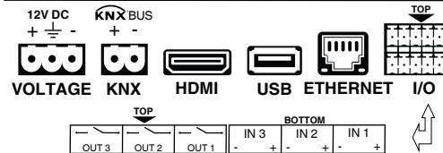
**VOLTAJ:** Interra dokunmatik paneler 12 V DC gerilim ile 3 pinli yeşil renkli endüstriyel bir özel konektör ile beslenmektedir. Pin göstergeleri cihaz kutusunun üstünde bulunmaktadır. 12 V güç kaynağının kablolari kutuplara uygun şekilde takılmışlardır.
