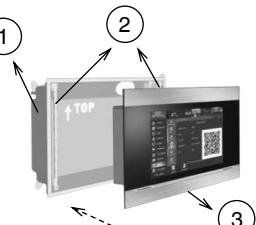
II. Anschließend wird als Nummer 1 das Schalttafelbaugehäuse in den zuvor geöffneten Schlitz so montiert, dass es sich auf einer Ebene parallel zum Boden befindet und die Pfeilmarkierung am Rahmen nach oben zeigen muss.
