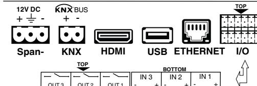
**Spannung:** Interra-Touchpanels werden über einen speziellen 3-poligen grünen Industrie-Spezialstecker mit 12 V Gleichspannung betrieben. Pin-Angaben sind auf dem Kunststoffgehäuse vermerkt. Die Kabel der 12V-Stromversorgung müssen entsprechend der Polarität gesteckt werden.
