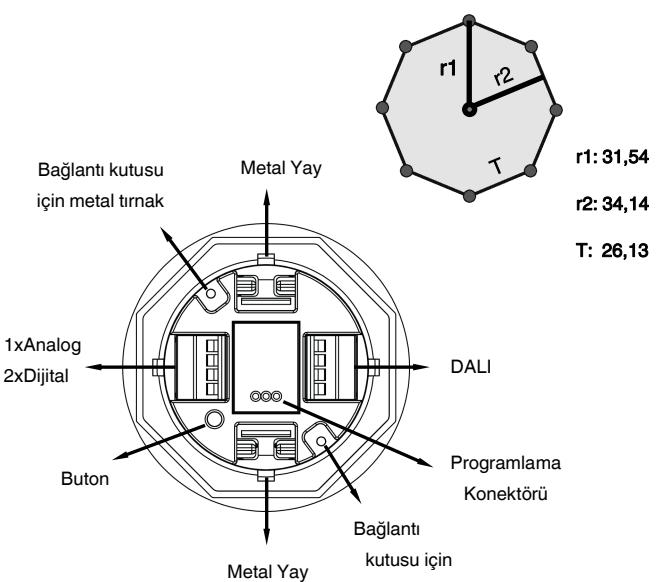
Cihaz tavanda, sıva altı montaj muhafazası ile sıva altına veya opsiyonel olarak temin edilebilen sıva üstü kasa sıva üzerine monte edilebilir.
