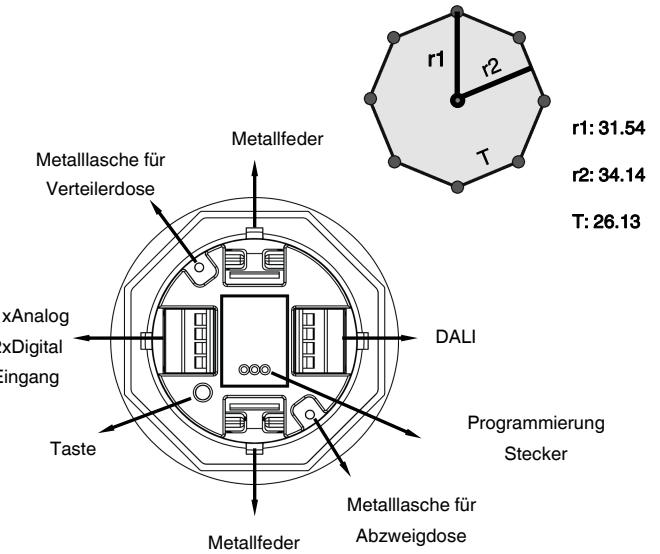
Das Gerät kann entweder in der Decke über das Unterputzgehäuse oder an der Decke über die optional erhältliche Aufputzdose montiert werden.
