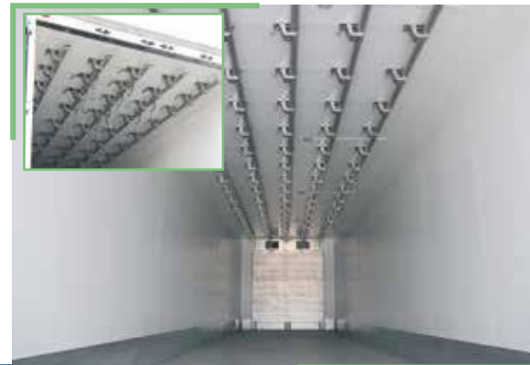
Комплектация с ХОУ, с защитой ХОУ, с системой для перевозки полутуш в подвешенном состоянии
