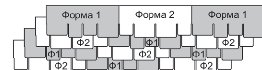
Рис. 20. Схема чередования гонтов гибкой черепицы Döcke LUX коллекции «Саппоро».
