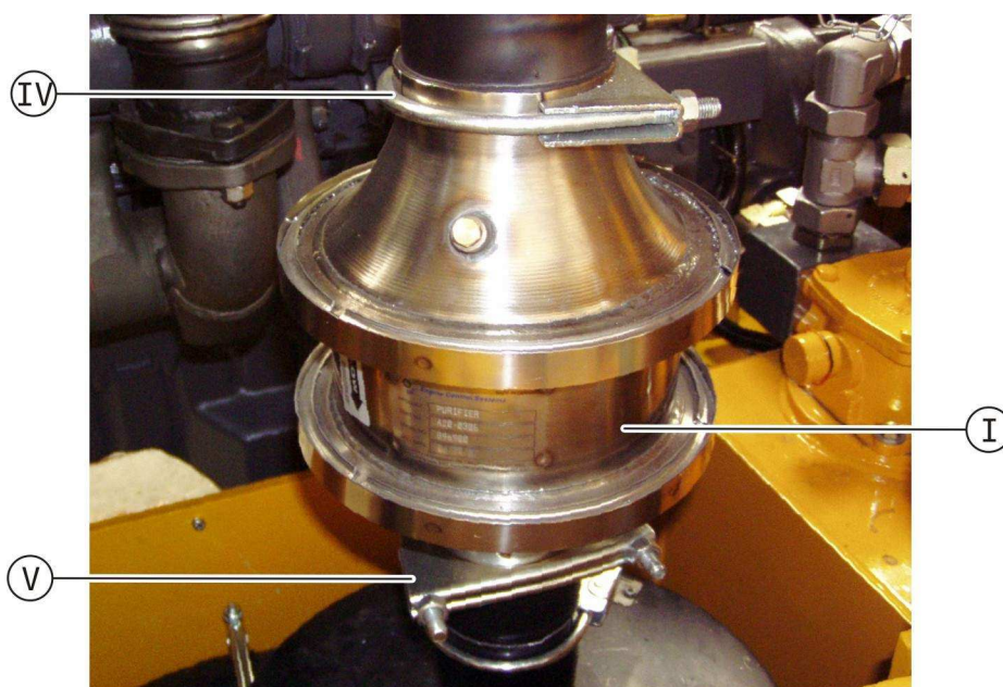
Fig. 7-8: Abrazaderas para montar/desmontar el catalizador
