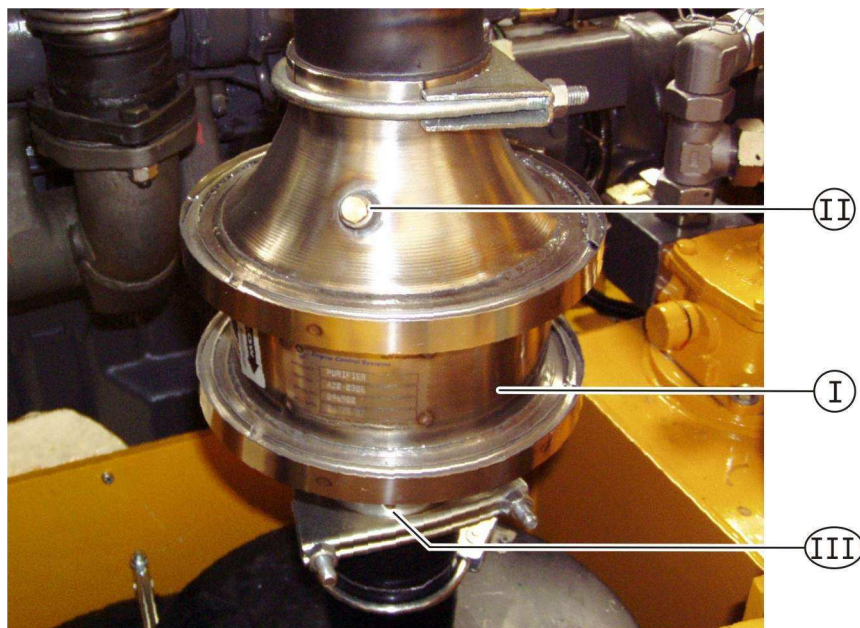
Fig. 7-7: Aberturas para medir los gases de escape en el catalizador
