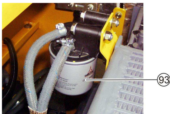
Fig. 7-2: Filtro de combustibles (I), tornillos de purga de aire (II)
