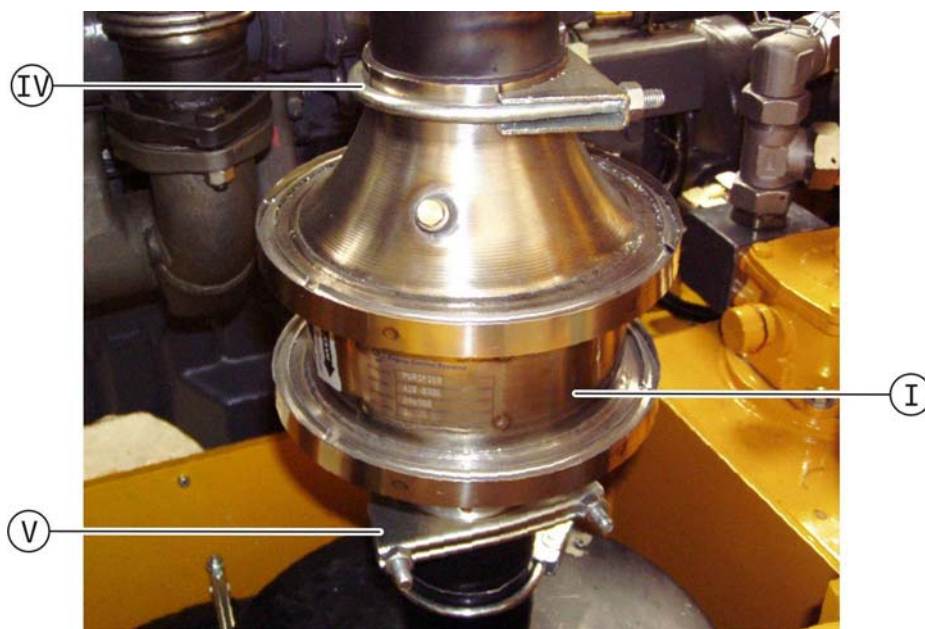
Fig. 7-16: Abrazadera para (des)montar el catalizador (opcional)
