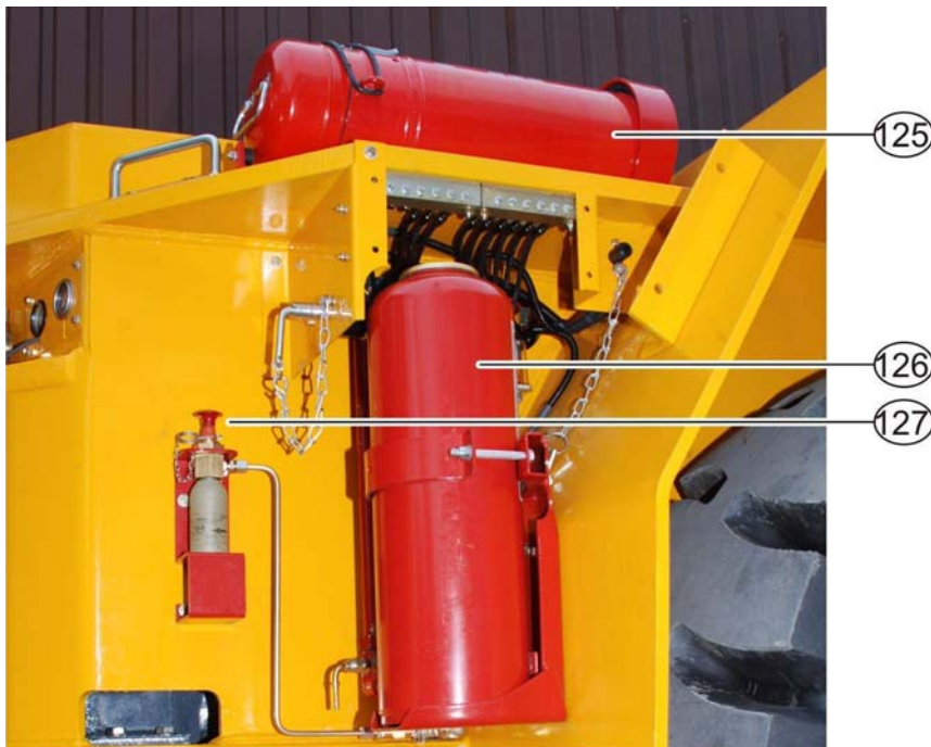
Ilustración 4-34: Sistema contra incendios semi-automático (opcional) referencia
