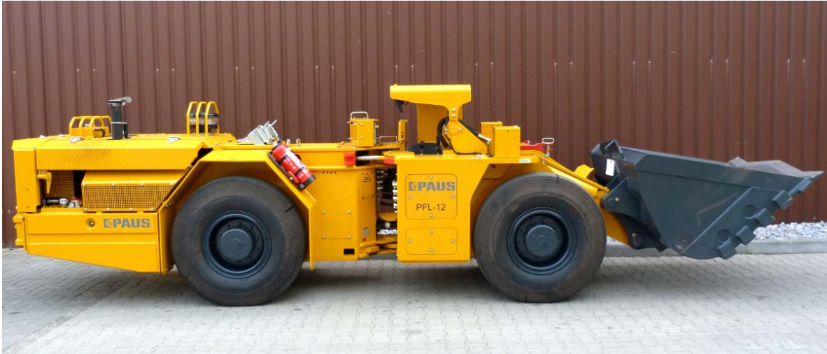
Ilustración 1-1: PFL 12 Cargador Frontal de Bajo Perfil para operación en Minería Subterránea
