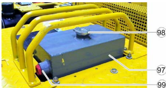
Ilustración 4-22 : Estanque compensador de refrigerante
