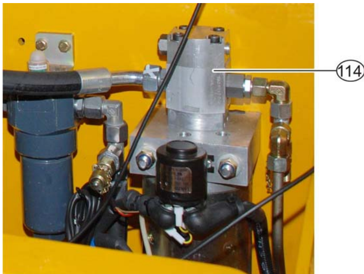
Ilustración 4-28: Bomba de emergencia para sistema de frenos (referencia PFL 45)
