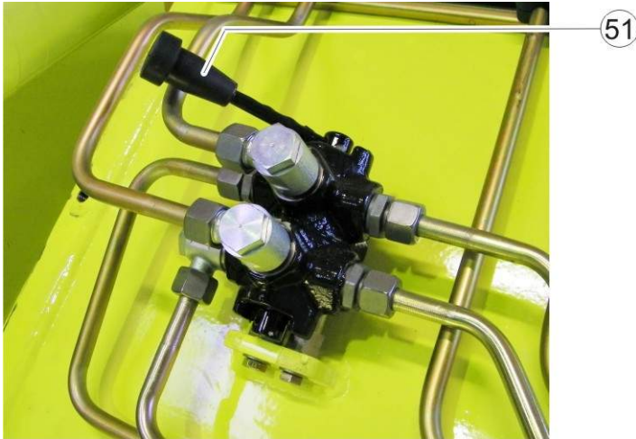
Ilustración 4-8: Dispositivo de desplazamiento de Horquillas (opcional)
