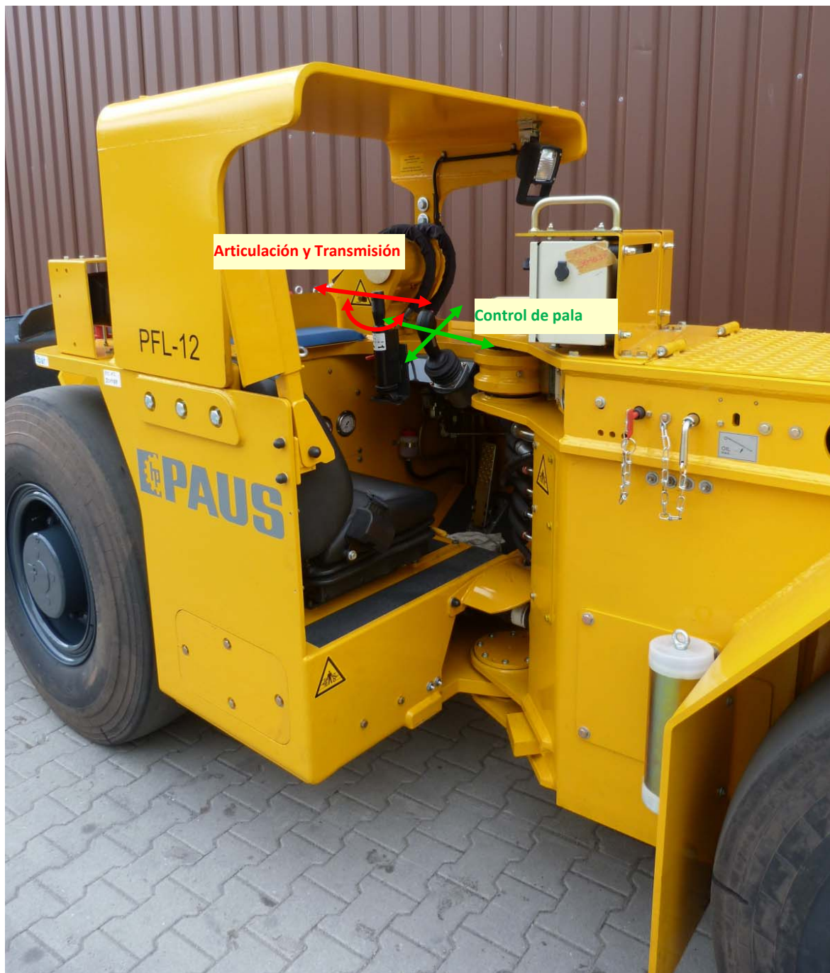
Ilustración 4-2: Puesto de operador en su Equipo Cargador Frontal Minero PFL 12
