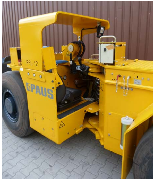
Ilustración 2-1: PFL 12 – Puesto de Operador
