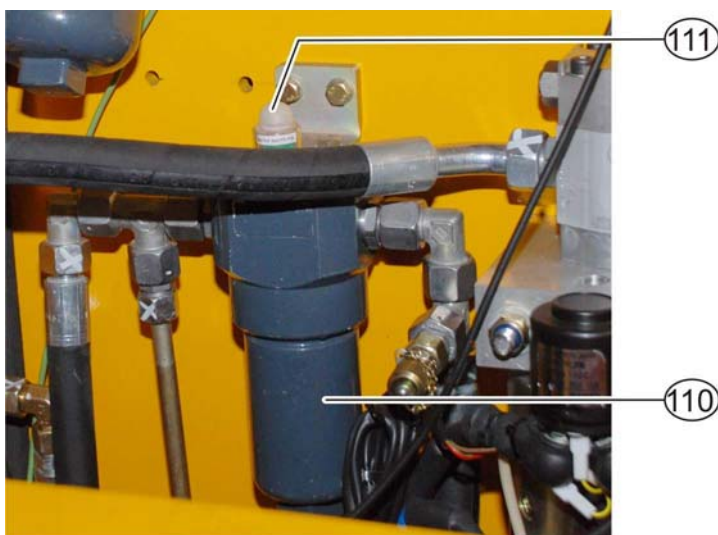
Ilustración 4-26: Filtro de presión sistema de frenos / indicador de contaminación (referencia PFL 45)
