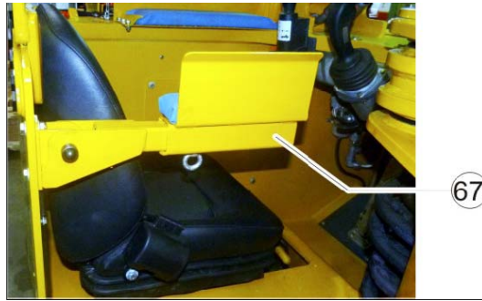
Ilustración 4-15: Apoyabrazos con basculación referencia PFL12
