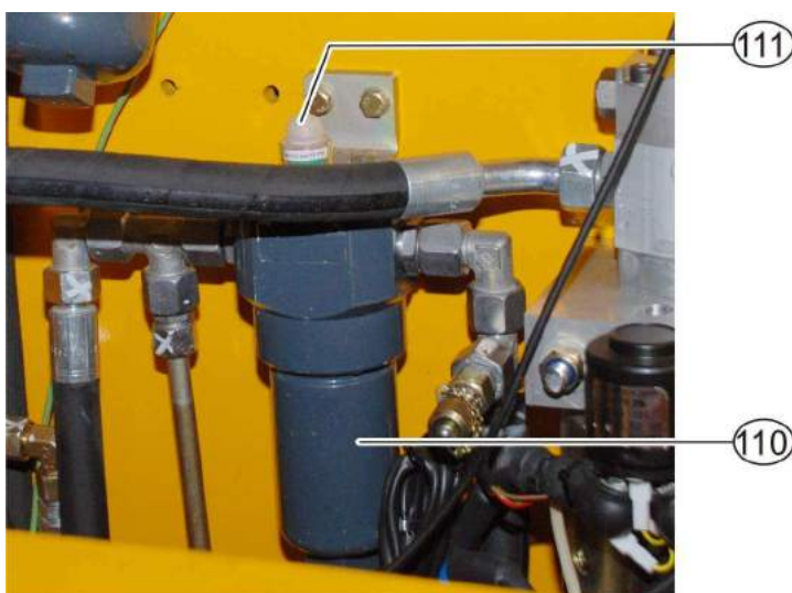
Ilustración 4-23: Filtro de presión sistema de frenos / indicador de contaminación (referencia PFL 45)
