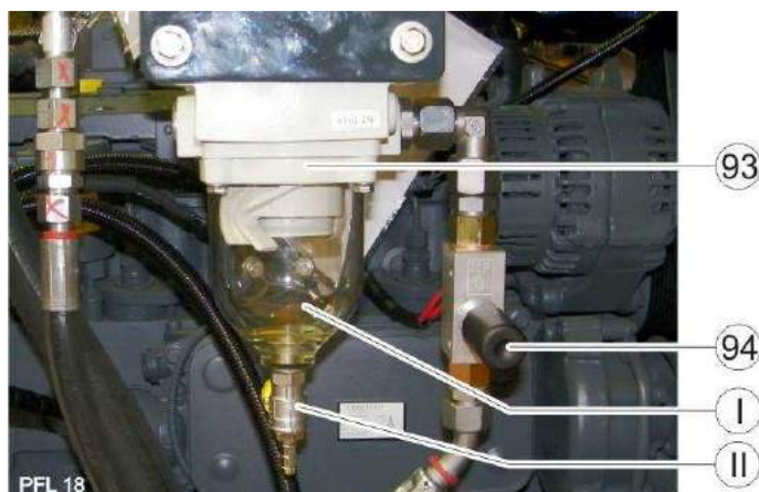
Fig. 7-6: Filtro Separ (opcional) / Bomba manual de combustible (PFL 18)
