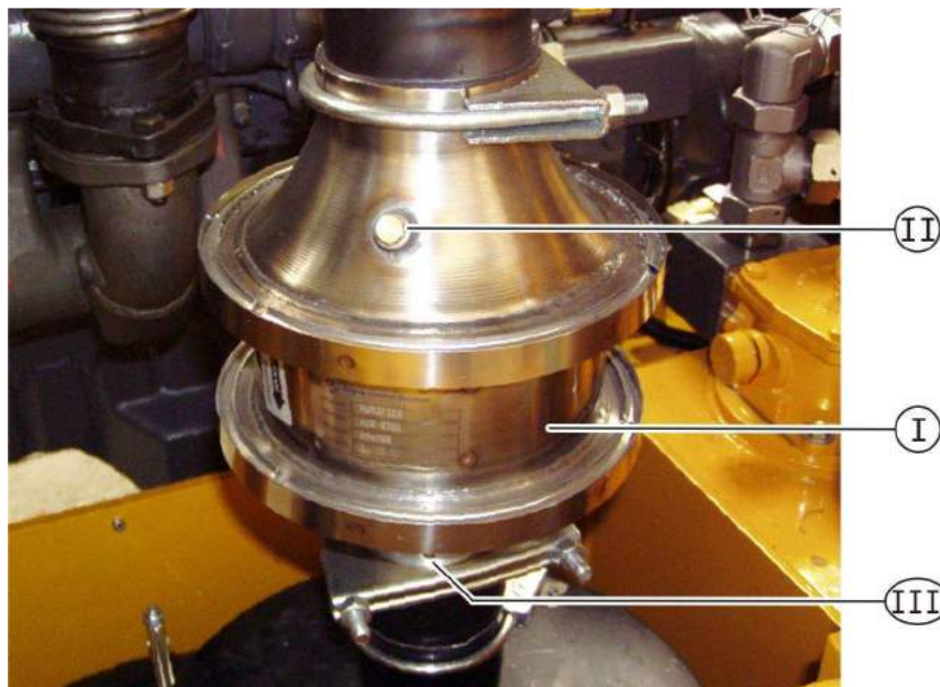
Fig. 7-15: apertura para la medida del escape en el catalizador (opcional)
