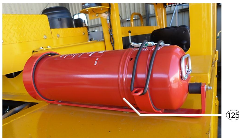
Ilustración 5-26: Extintor manual portátil en el área de la cabina del conductor
