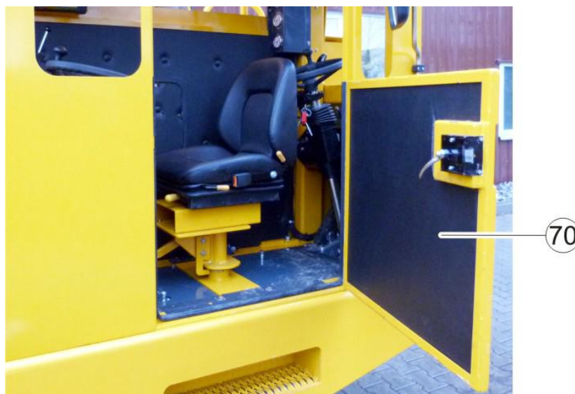
Ilustración 5-9: Puerta de seguridad de cabina
