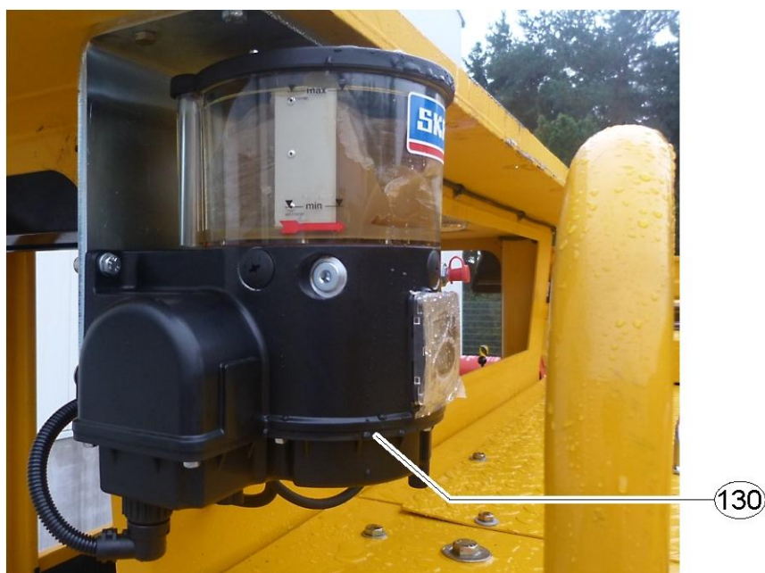
Fig. 4-3: Tanque de la lubricación centralizada en el lado izquierdo de la máquina
