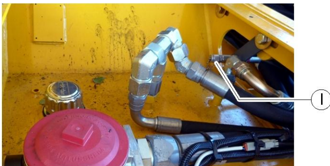
Ilustración 8-15: El acople de medición del sistema de oscilación del eje, detrás del filtro llenador del estanque hidráulico
