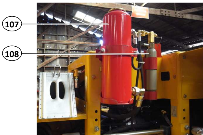
Ilustración 4-32: Sistema contra incendios, agente y cápsula de gas
