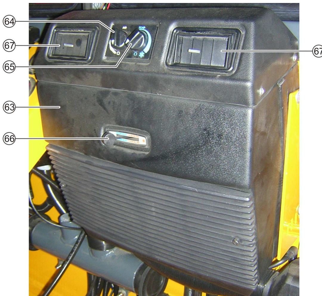
Ilustración 4-15: Sistema de aire acondicionado
