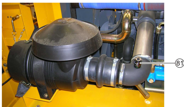
Ilustración 4-18: Indicador de contaminación del filtro de aire
