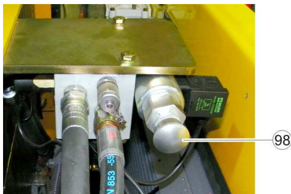
Ilustración 4-26: Válvula de circuito freno de estacionamiento, 1) detrás de cabina operador o 2) debajo de cabina operador
