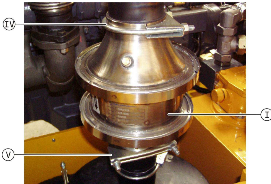
Ilustración 7-9: Abrazaderas de fijación para el montaje del catalizador
