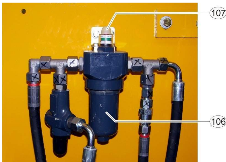
Fig. 4-22: Indicación de suciedad filtro de presión del sistema de frenos (Imagen de muestra)
