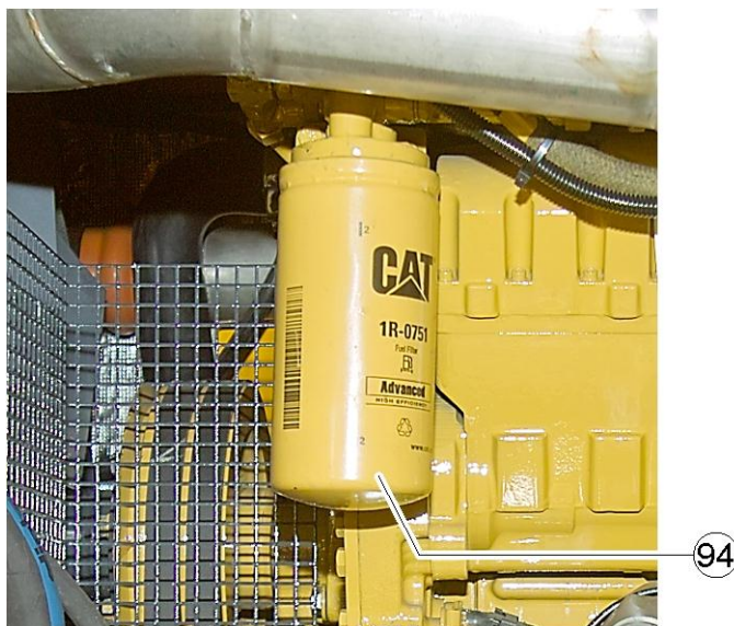
Fig. 4-16: Filtro de combustible
