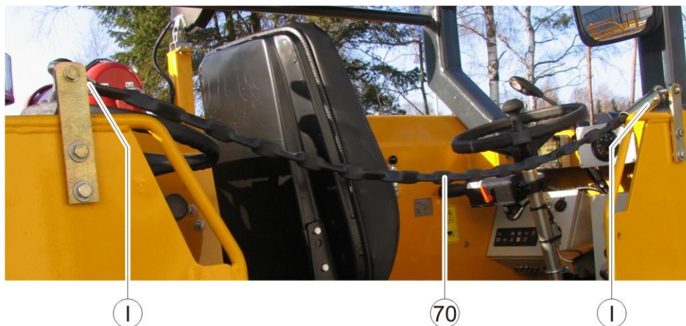
Fig. 4-11: Cadena de seguridad sólo en caso de puesto de conductor abierto
