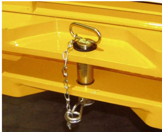
Fig. 8-2: Argolla de remolcado en la parte trasera de la máquina (Imagen de muestra)
