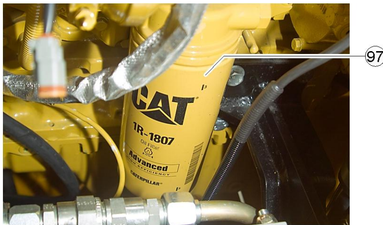
Fig. 7-3: Filtro de aceite de motor (97)
