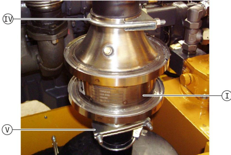
Fig. 7-12: Grapas para el desmontaje / montaje del catalizador (Imagen de muestra)
