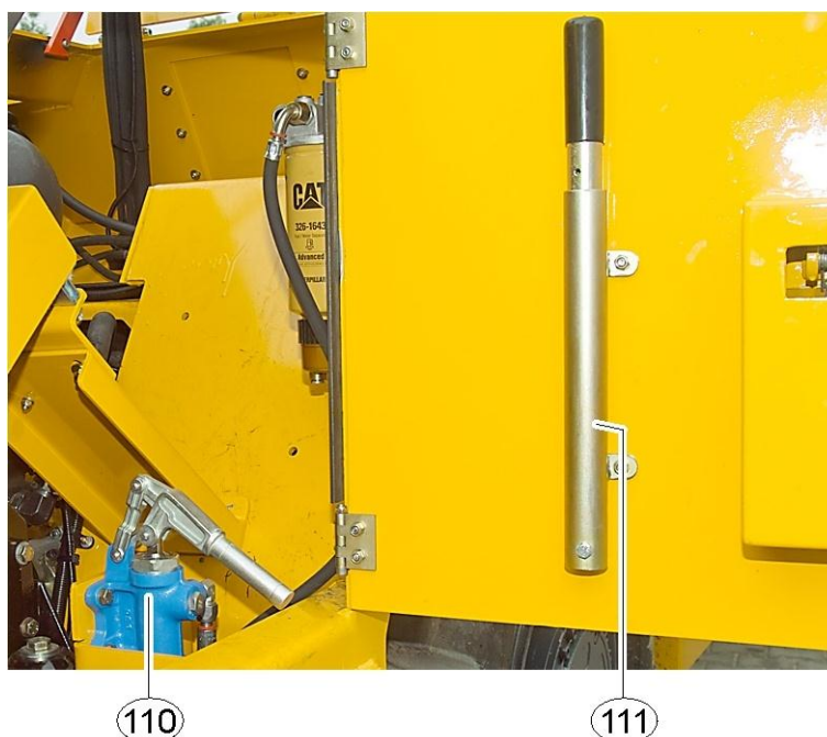
Fig. 4-24: Bomba manual de emergencia para soltar los frenos
