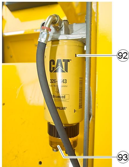
Fig. 4-15: Filtro de combustible
