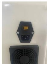
10. Выключатель электропитания и гнездо подключения к сети (220 В).
