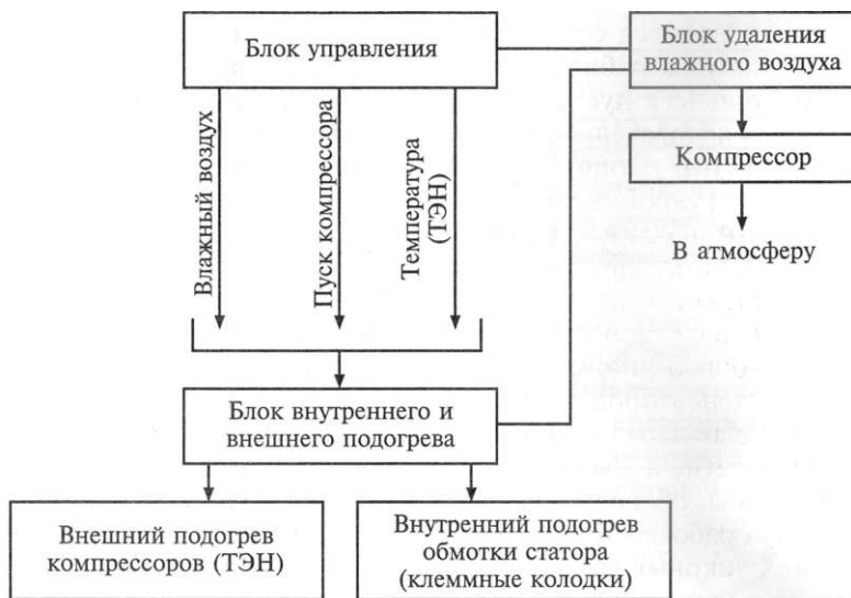
Рис. 8.4. Схема осушки компрессоров холодильных агрегатов
