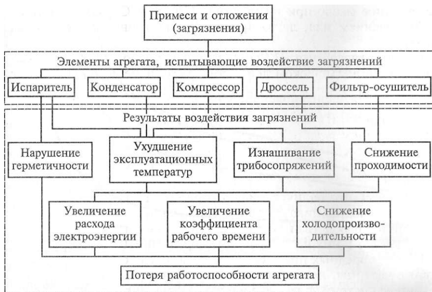
Рис. 2.3. Влияние загрязнений рабочей среды на работоспособность холодильного агрегата
