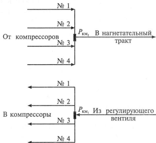
Рис. 8.10. Схема подключения компрессоров для осушки
