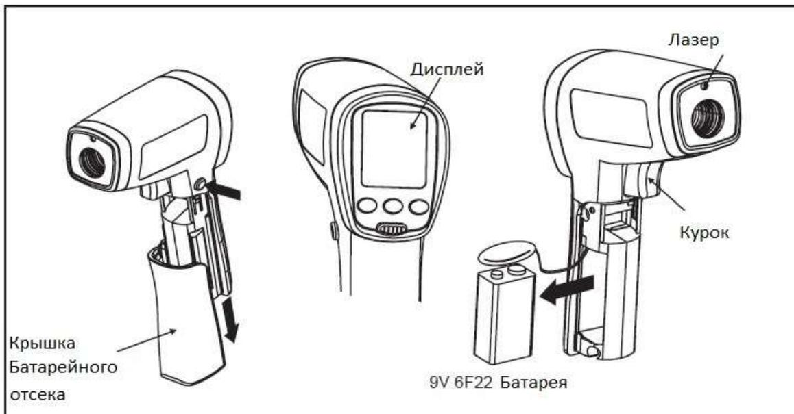
Термометр имеет в своем составе :
