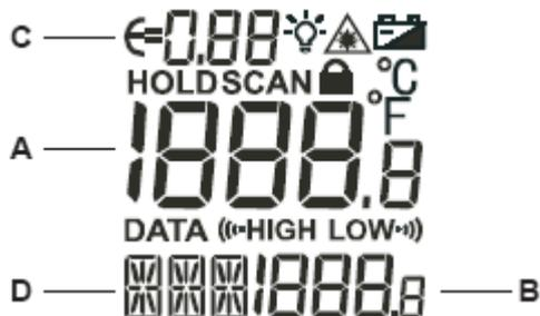
Первичный индикатор температуры А показывает текущую температуру объекта или температуру, измеренную в последние 8 секунд с момента отпускания курка.
