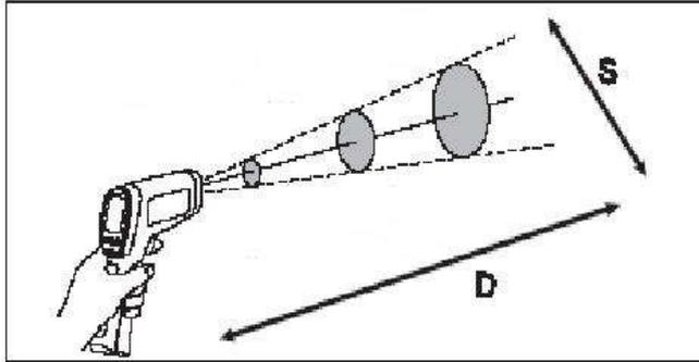
Размер области, температура которой отображается на дисплее термометра , находится в прямой арифметической зависимости от расстояния от термометра до объекта и вычисляется с помощью коэффициента. Таким образом, чем больше расстояние до объекта – тем больше размер измеряемой области.
