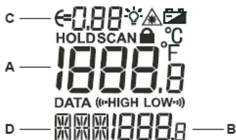
Первичный индикатор температуры А показывает текущую температуру объекта или температуру, измеренную в последние 8 секунд с момента отпускания курка.
