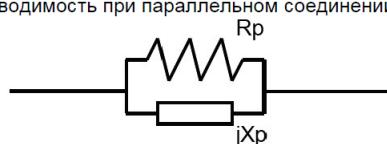
$R_p$ : активное сопротивление при параллельном соединении
