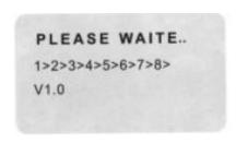
После выбора функции проверки карты кабеля (**WIREMAP**), тестер должен выполнить процедуру проверки схемы разводки кабеля (WIREMAP) и на дисплей выводится сообщение о процессе измерения.
