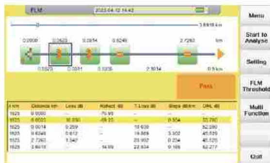
Тест сплиттеров 1x8 + 1x8
