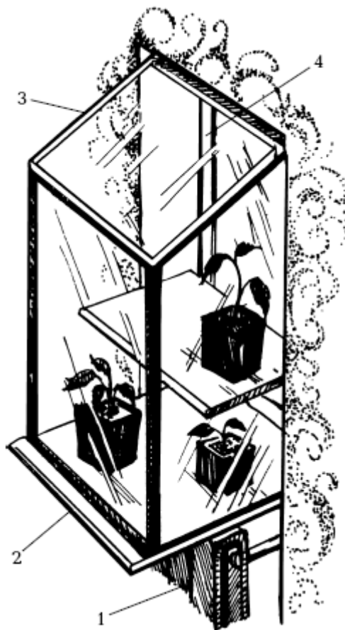
Рисунок 72. Самодельная мини-тепличка: 1) радиатор; 2) расширенный подоконник; 3) фрамуга; 4) оконная рама
