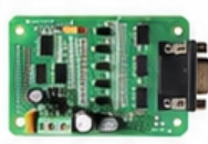
Плата инкрементального энкодера MCTC-PG-D
