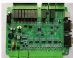
Плата крыши кабины (MCTC-CTB-A2-Ver L00)
