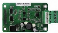
Плата инкрементального энкодера MCTC-PG-A2
