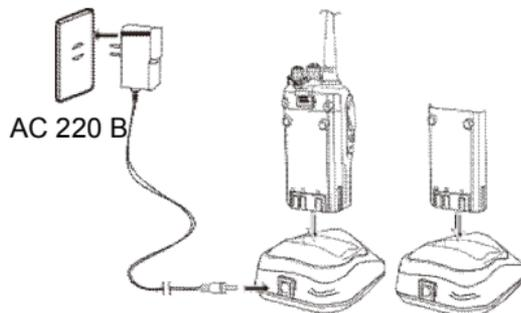
Примечание: когда заряжается включенный трансивер, индикатор не загорится зеленым светом, показывая что процесс зарядки завершен. Только если трансивер выключен, индикатор будет работать нормально. Включенный трансивер потребляет энергию и индикатор не может определить, завершен ли процесс зарядки. Поэтому индикатор показывает неверный статус зарядки.
