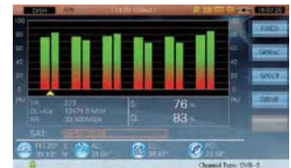
Отображение качества сигналов макс. 12 транспондеров для регулировки положения тарелки спутниковой антенны
