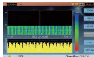
Отображение коэффициента ошибок модуляции (MER) в сравнении с уровнем несущей для поиска внутриканальных помех
