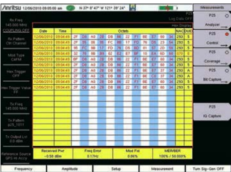
На экране канала управления P25 отображаются данные в нисходящем канале транкинговой системы в шестнадцатеричном формате. Компания Anritsu предлагает бесплатный скрипт для преобразования информации в шестнадцатеричном формате в текстовые сообщения.
