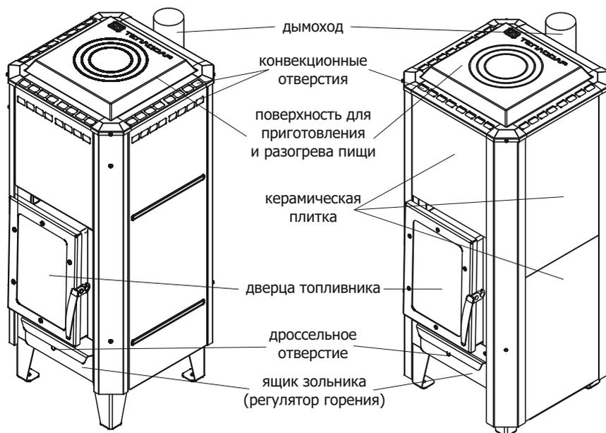
Схемы установки печи "Вертикаль-Металлика"
