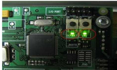
Рис.1.1. Индикаторы DEFAULT и CPU
