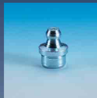
Прессмасленки под запрессовку С гладкой ножкой прямой или конусной формы во всех возможных размерах и исполнениях от Ø 5 мм до Ø 10 мм
