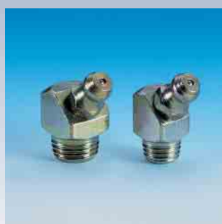
Стандартные прессмасленки H/S С саморезающей резьбой (180°/45°/90°), Form А, В, С по DIN 71412 твердость поверхности 650 HV
