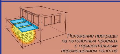
Положение преграды на потолочных проёмах с горизонтальным перемещением полотна
